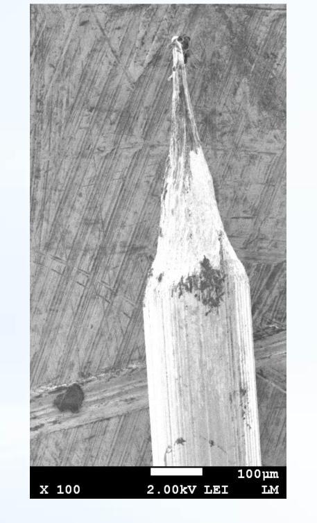
Cathode:  $6H_2O + 6e^- \rightarrow 3H_2(g) + 6OH^-$ Anode:  $W(s) + 8OH^- \rightarrow WO_4^{2-} + 4H_2O + 6e^-$ Overall:  $W(s) + 2OH^- + 2H_2O \rightarrow WO_4^{2-} + 3H_2(g)$
